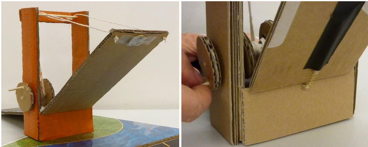
Figura 9. È possibile utilizzare una moneta o una molla per abbassare il ponte.
