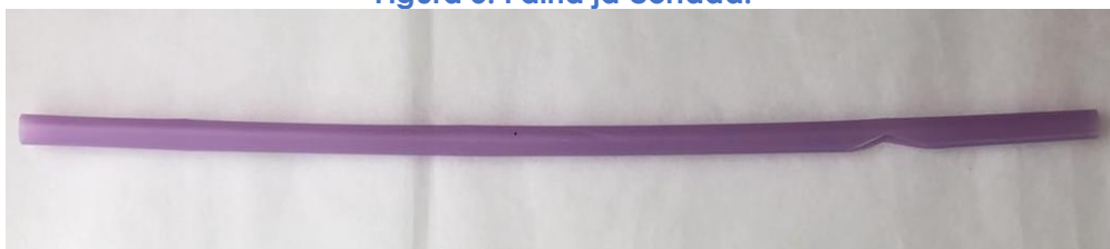
Figura 6. Depois de aberta a dobra, a palha tem um buraco em forma de losango.
