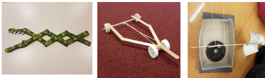
Figura 10.2 Os autómatos que utilizámos com os/as estudantes de formação inicial ECEC: um crocodilo, com um mecanismo de braço de tesoura, um carro com um elástico como motor e uma turbina eólica que alimenta um guincho.
