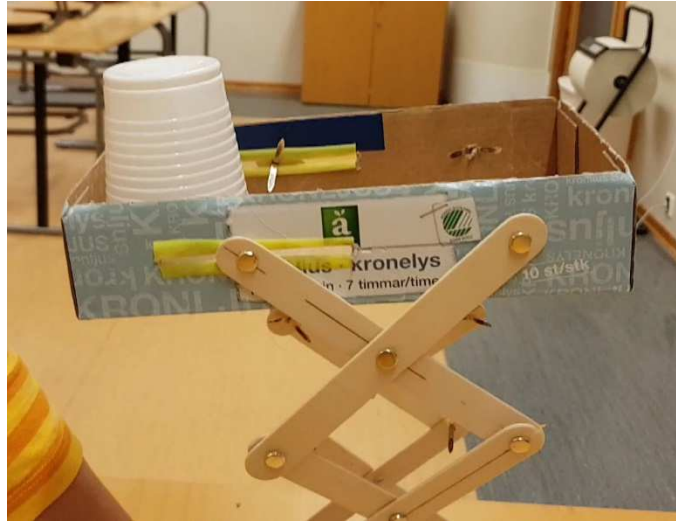
Figura 15: Un sollevatore a forbice con collegamento a manovella e a cursore
