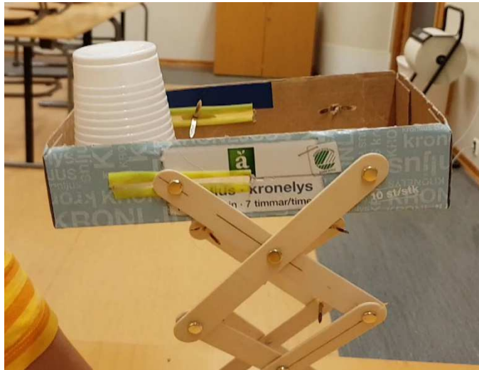
Фигура 8: Ножичният повдигач използва плъзгаща се връзка
