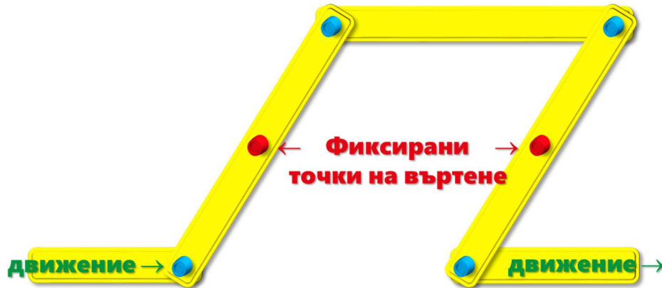
Фигура 50: Връзка на паралелното движение
